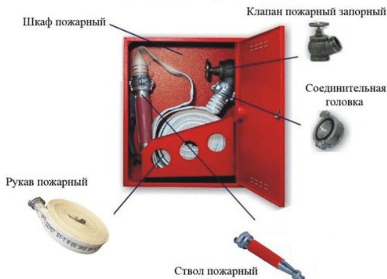
Рис. 2 Устройство пожарного крана
